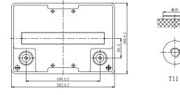
Note: Terminal Torque Values in-Ib(Nm):97.28-130.0(11.0-14.7)
